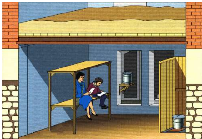
Рис. 4 — Подвал, приспособленный под укрытие
